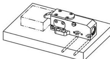
Raccordement inférieur. Les raccords latéraux doivent être fermés. Les vis de fermeture sont incluses.
