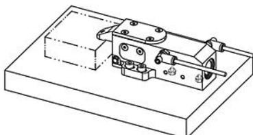
Raccordement latéral comme indiqué. Les raccords inférieurs doivent être fermés. Les vis de fermeture sont incluses.
