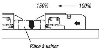
Le bras de serrage est actionné par un mécanisme. En cas de baisse de pression suite à une fuite d'air, le mécanisme empêche une baisse rapide de la force de serrage.
